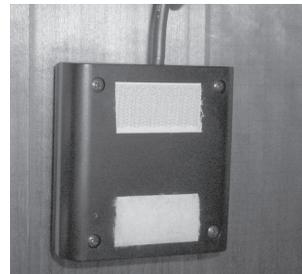
Drücken Sie das Tastergehäuse mit den aufgeklebten Klettstreifen am gewünschten Montageort gegen die Wand.
