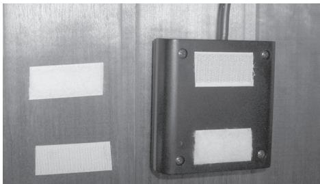
Abschliessend befestigen Sie den Taster wieder und führen die Anschlussleitung zur Steuerung
