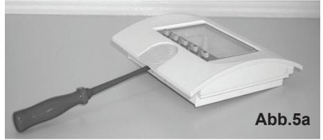
Anschließend muss das Gehäuseoberteil an den hinteren Befestigungslaschen ausrasten (siehe Abb. 6).
